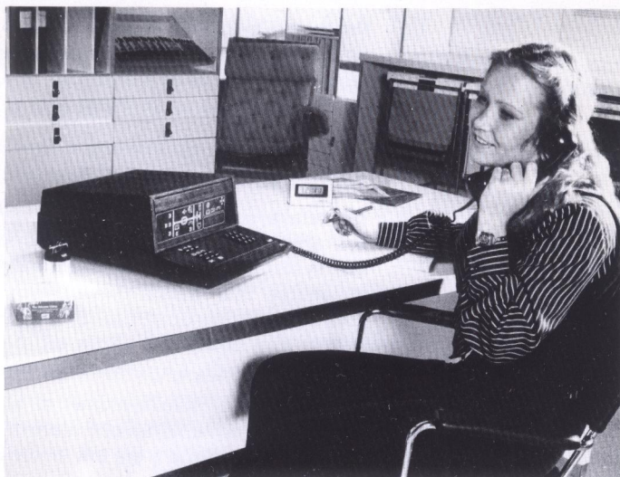
Datorstyrd abonnentväxel ASB 100 för 20-100 anknytningar.
